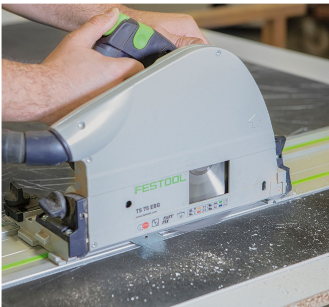
Zuschnitt mit Handkreissäge und Führungsschiene
